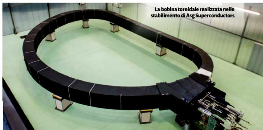
La bobina toroidale realizzata nello stabilimento di Asg Superconductors
